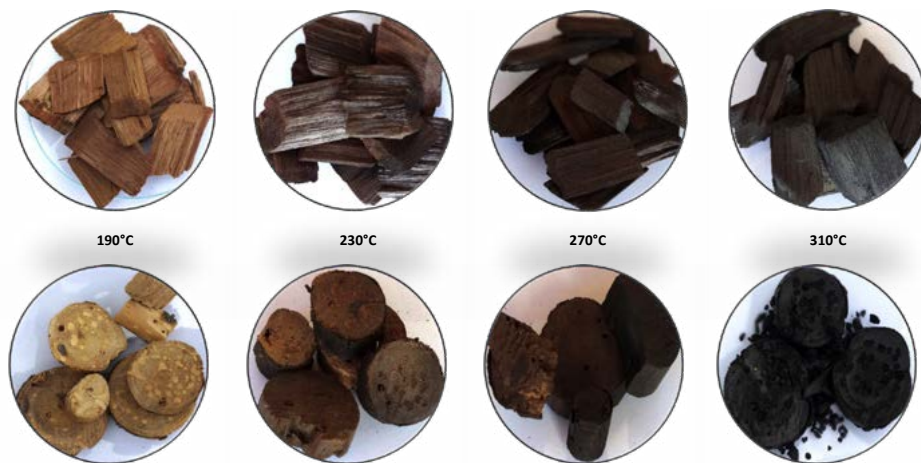
Biomassas torrefeitas a diferentes temperaturas, tendo na parte superior o eucalipto e na parte inferior a algaroba
